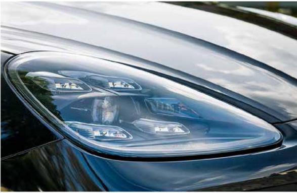
Das Top-System unter den Scheinwerfern: Der LED-Matrix-Hauptscheinwerfer mit PDLS Plus ermöglicht Fernlicht, ohne den Gegenverkehr zu blenden.
